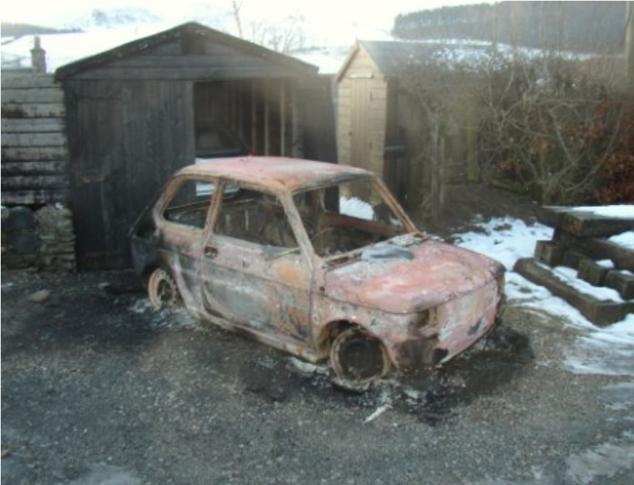
Un incendie dans une batterie au lithium fer phosphate a totalement détruit ce véhicule électrique de bricolage, faisant fondre du verre et de l'aluminium. (Photo Greg Fordyce, février 2009)
