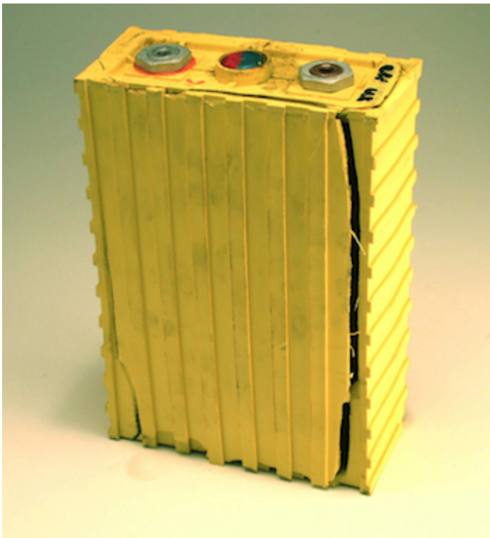
Cette cellule Winston a augmenté la pression jusqu'à ce que le boîtier explose.
