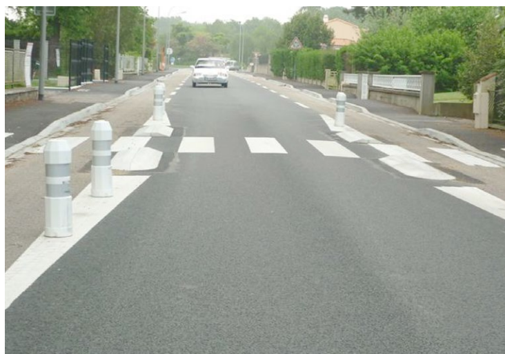
Rappel de la CVCB par aménagement d'une écluse simple avec rétrécissement axial.
