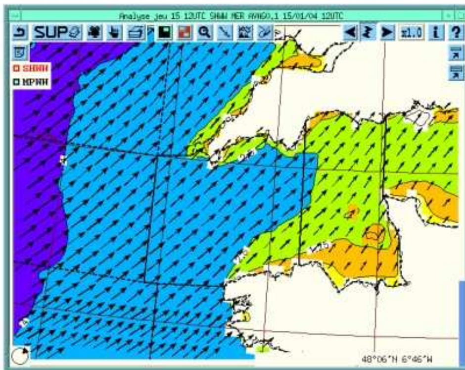
Carte d'analyse de la mer du vent [H 1/3, direction et période] (modèle Alad-Vag0.1)
