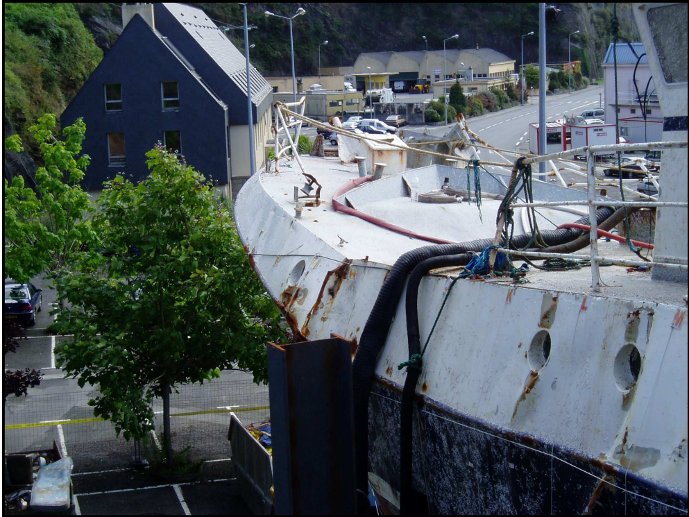
Vue des déformations au niveau du pont supérieur avant. La timonerie est située à droite de la photographie.
