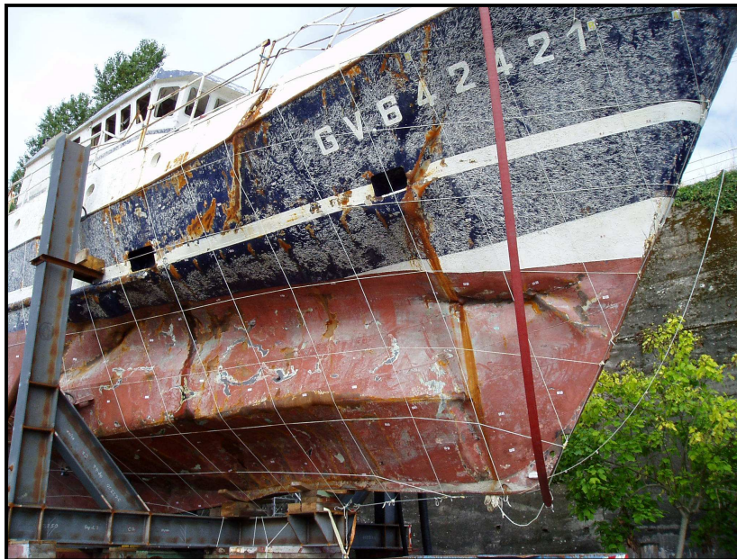
Vue des déformations côté tribord. La photographie montre les déformations au niveau de la cale à poissons et du double fond situé dessous. On voit également la déformation de la quille.
