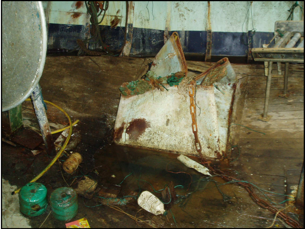
Déformation de l'écotille de chargement du poisson à tribord avant de la salle de travail.
