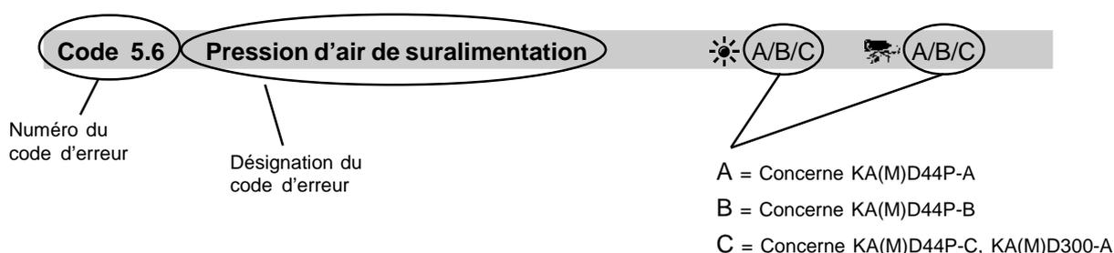
**N. B.** L'accès à une information complète permettant de lire et d'annuler l'ensemble des codes d'erreur requiert l'utilisation de la clé de diagnostic ou du programme de diagnostic pour PC. Ces outils de diagnostic se raccordent via la prise de diagnostic du moteur située dans le boîtier de connexion électrique. Le modèle KA(M)D44P-A comporte également une prise de diagnostic sur le câblage EDC au poste de commande.
