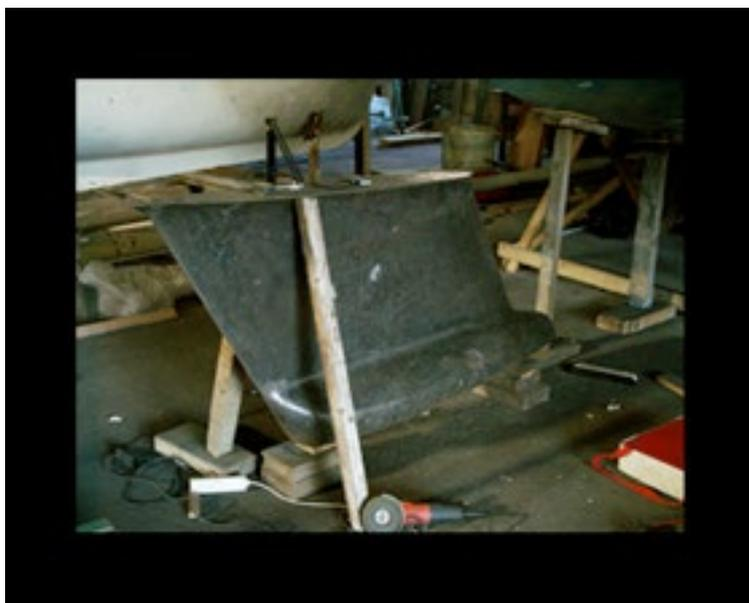
8 boulons neufs inox A4 de 14mm et 4 boulons neufs inox A4 12MM (ceux des extrémités) ont été achetés dans un magasin nantais pour une fixation au mastic polyuréthane SILKA.
