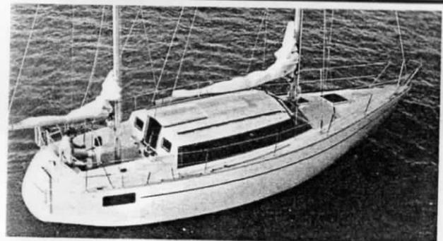
L'arrière est volumineux et abrite désormais le cockpit et deux cabines doubles. Le passage du cockpit central (Mallard 10,40 m) ou cockpit arrière (Septentrion) a permis de retenir des solutions d'emménagements plus intéressantes mais le poids de l'équipage plus reculé risque d'accentuer le cabrage naturel, procuré par la marche au moteur.
