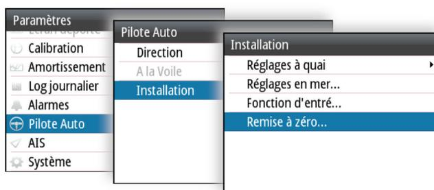
*Réinitialisation du calculateur de pilotage automatique, AP48*
