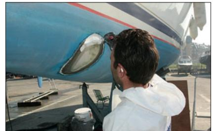
▲ Arnaud passe du gel-coat sur le pourtour du tunnel afin de protéger la stratification.
