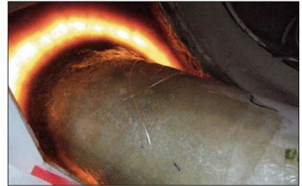
▲ Le tube est stratifié à la coque à la fois par l'intérieur et par l'extérieur.
