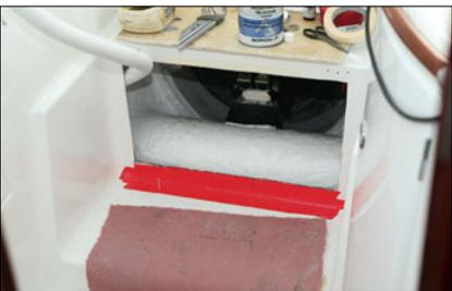
▲ Le gel-coat est également appliqué sur le tube à l'intérieur dans un souci de finition.
