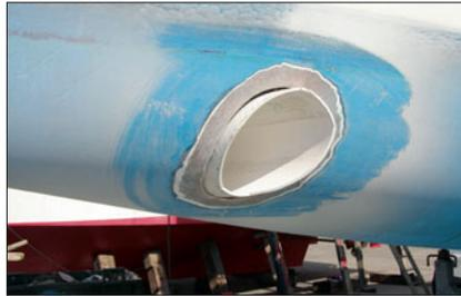
▲ Lors de sa mise en place, le tube doit dépasser de la coque vers l'avant et affleurer vers l'arrière.
