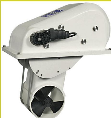
▲ Les modèles rétractables basculants comme ce Compact Retractable Max Power (environ 5 000 €) conviennent particulièrement aux bateaux à fond plat (ici un Océanis 34). Ils ont aussi l'avantage de limiter au maximum la traînée hydrodynamique.
