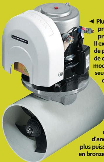
◀ Plusieurs fabricants proposent des propulseurs en tunnel. Il existe des différences de puissance, mais aussi de configuration, certains modèles proposant une seule hélice et d'autres deux. Chez Lewmar, les petits modèles comme ce 140 TT (à partir de 1 000 €) sont équipés d'hélices en composite (qui ne nécessitent pas d'anodes) et les modèles plus puissants, d'hélices en bronze.
