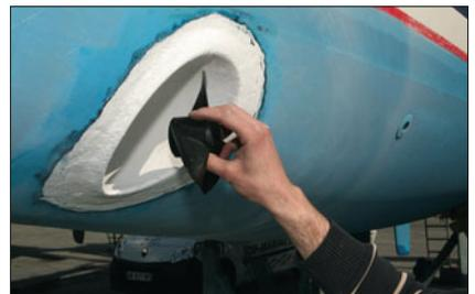
▲ Une fois les hélices posées, ne restera plus qu'à passer un antifouling, y compris dans le tunnel.
