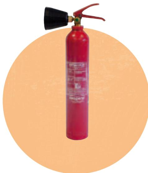
La température du CO<sub>2</sub> à la sortie du diffuseur est de - 52°C à l'état de gaz et de - 78°C à l'état de neige carbonique. La détente du gaz crée donc un froid intense. Pour éviter les gelures, il faut tenir l'extincteur par les poignées prévues à cet usage (gâchette, poignée isolante...) et non par l'organe de diffusion.
