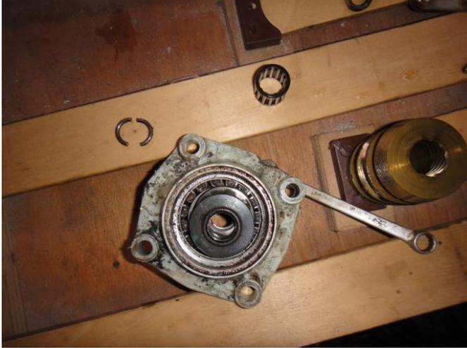
Après, retirer le petit levier de vitesse sur le coté, 2 boulons qui se retirent avec une clé de 13 et le sortir et après pour pourrez retirer le cône par le dessus en prenant soins de retirer le petit roulement à aiguille qui se trouve au dessus du cône et le tour est joué, mois de 10mm de démontage.
