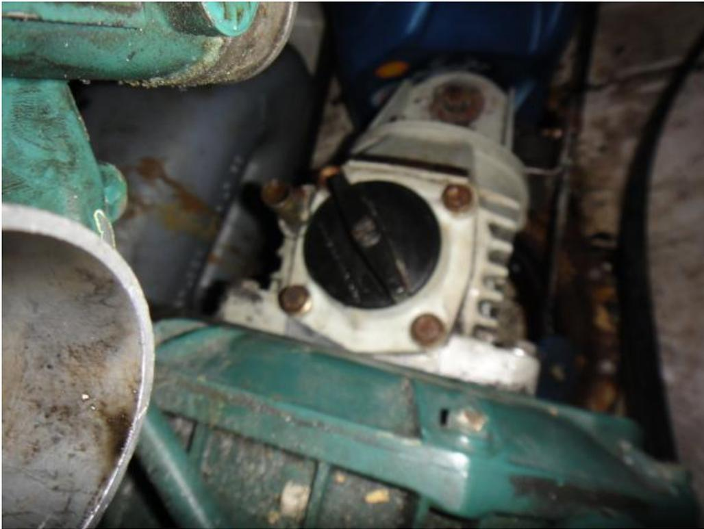
Visser l'outil à la place des 2 boulons en diagonal jusqu'à ce que la grosse rondelle libère les deux demi clips inox coincés dans l'axe et les retirer avec une pince à épiler, aucun danger qu'ils tombent dans la boîte .
