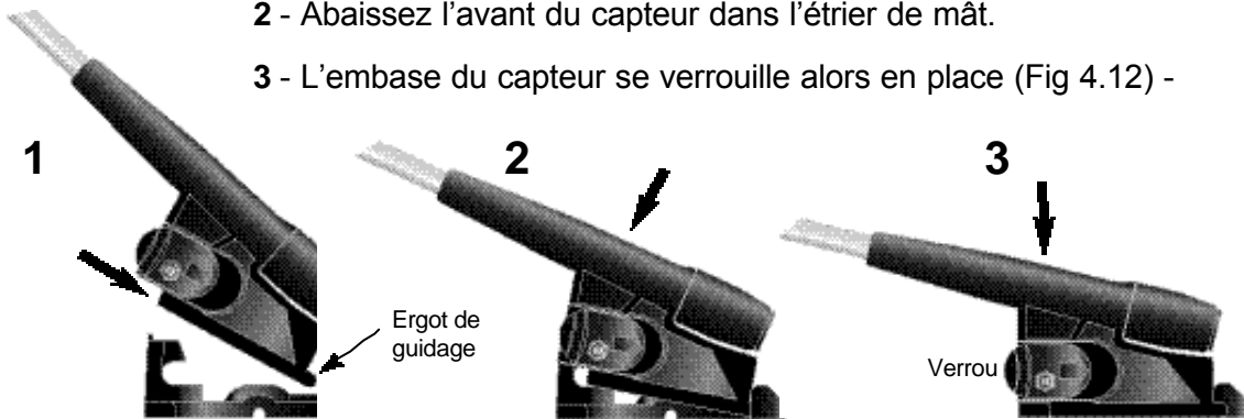
Fig 4.12 - Fixation de l'unité de tête de mât
