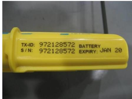
5.1 : Insérez la nouvelle étiquette de date et d'heure de la batterie, et vérifiez que le numéro de série et l'identifiant TX sont toujours lisibles.
