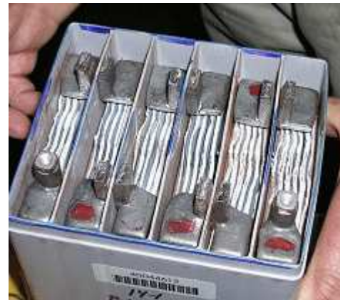
Intérieur d'une petite batterie
