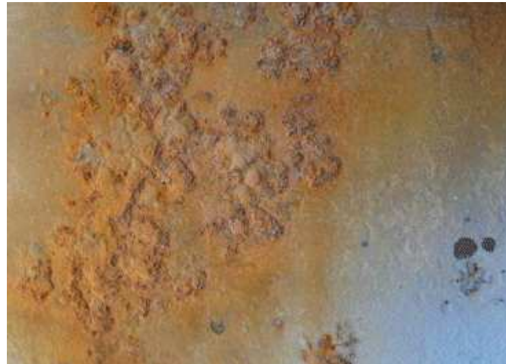
Corrosion electrolytique – bateau sous-protégé
