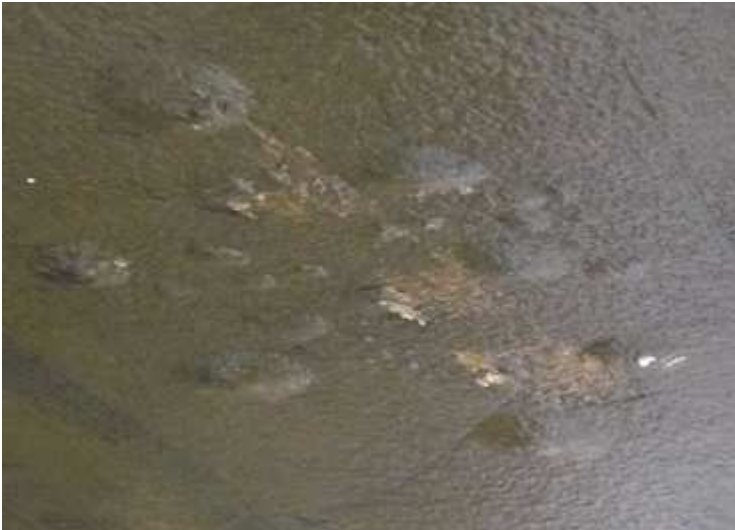
Cloques (hors osmose) – bateau sur-protégé
