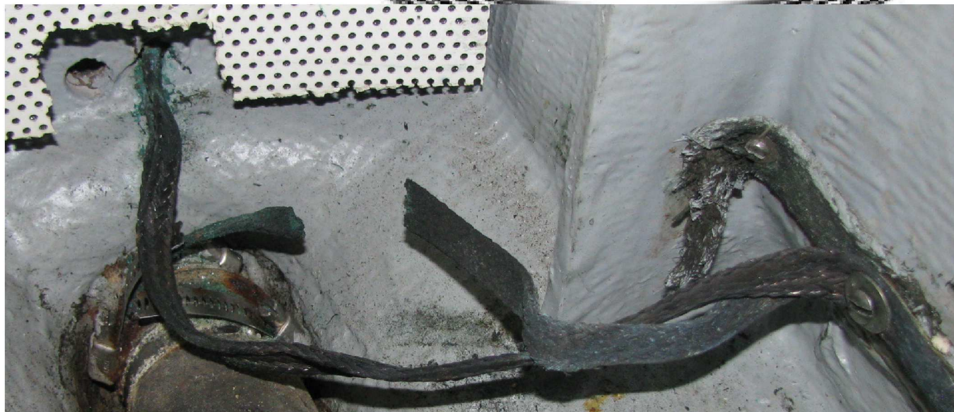
Tresse 50mm 2 étamée avec oeillets. Utile si entretenue
