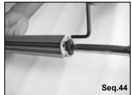
Engager la vis de butée dans la gorge de ralingue et serrer la vis de butée. Fit the stop screw into the luff groove and tighten the top screw.
