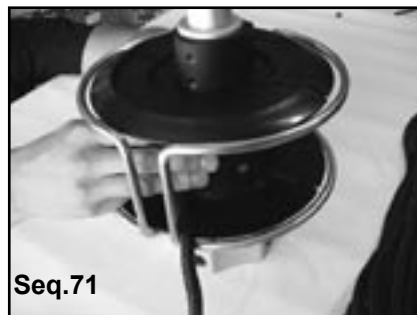
Faire ressortir le cordage tel qu'indiqué Place the furling line as shown
