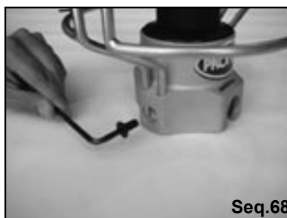
Dévisser les vis de bras arceaux. Unscrew the drum cage screws.
