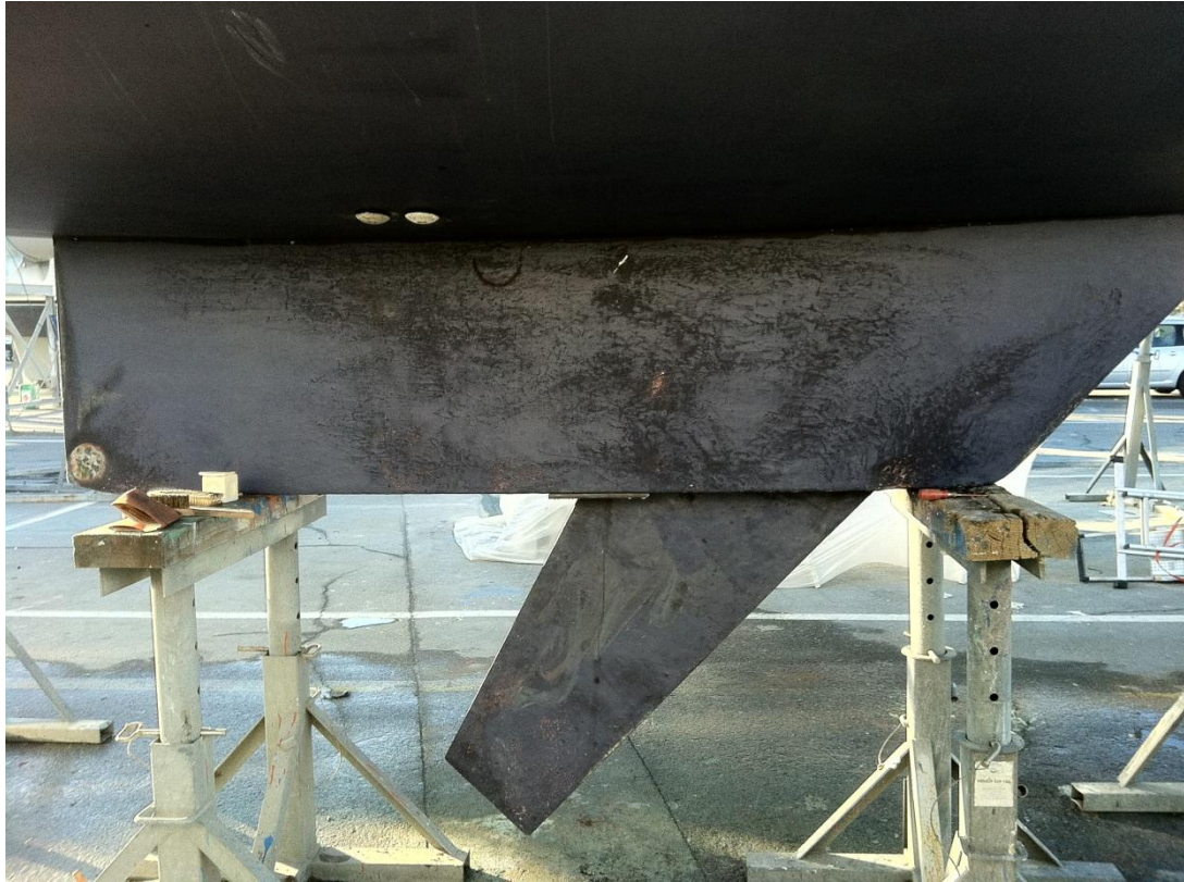
Position réelle de la dérive en position basse
