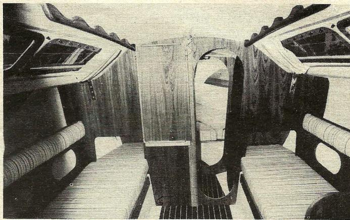
Encore un "carré" tout en largeur ! La table de repas pliée contre la cloison de mât dégage totalement la surface importante de plancher laissée libre entre les couchettes.
