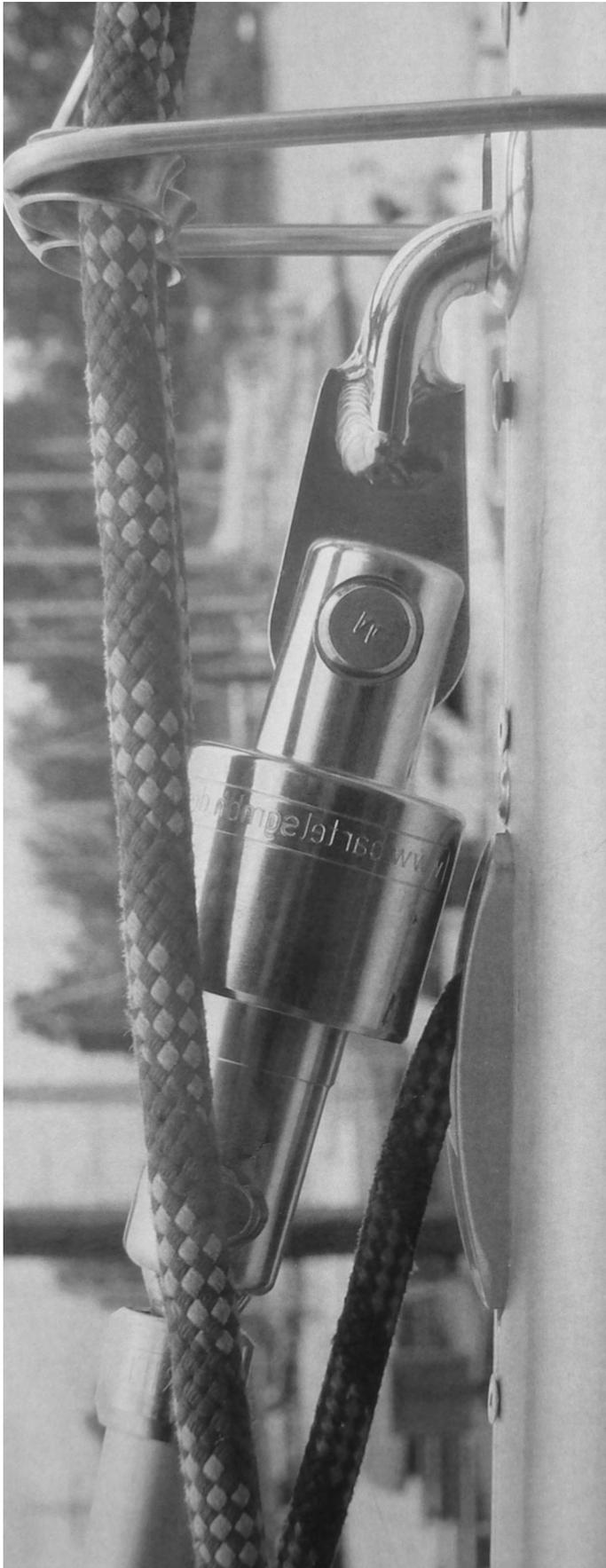
Dans tous les systèmes à coulisseau émerillon, la drisse une fois hissée doit faire un angle de 5 à 10 degrés avec l'étai et la distance entre le coulisseau émerillon et le réa de mât doit être aussi courte que possible. Il faut dans ce cas tenir compte de l'allongement de la ralingue afin que le coulisseau pour drisse en câble une fois complètement hissé, ne bute pas contre l'embout supérieur.
