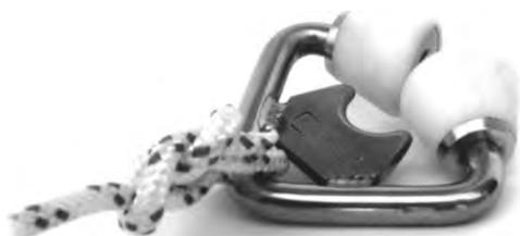
L'endrailleuse élimine le besoin d'un second équipier sur la plage avant. (Référence produit: S)
