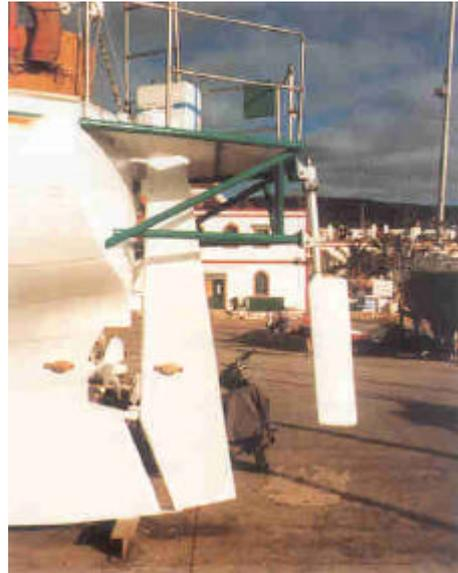
Le rapport de taille optimal entre la pale du safran principal et celle du safran auxiliaire est de 3:1.
