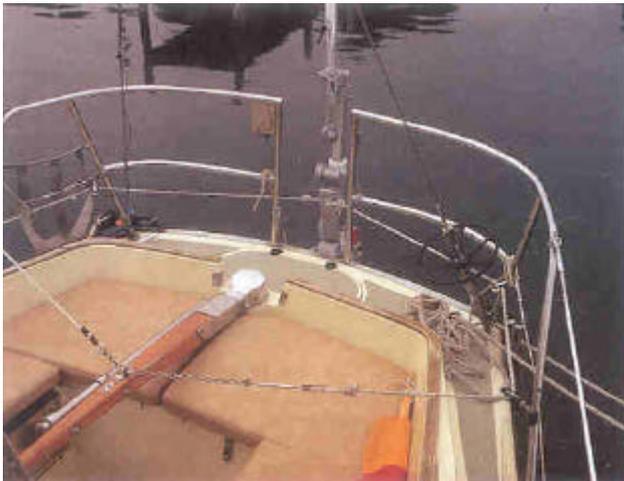
Transmission courte d'un régulateur Windpilot Pacific. Les drosses sont reliées au bras de transmission du pendulum à hauteur du pont.
