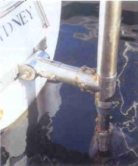
Ce système BWS-Taurus aurait intérêt à reposer sur un bâti support en V.
