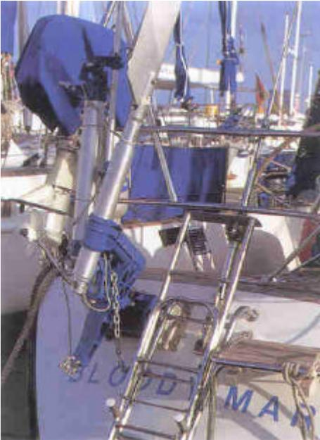
Un système à safran pendulaire assisté excentré n'est jamais réellement performant.
