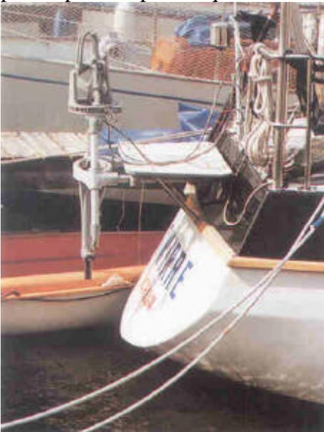
Sur les tableaux positifs modernes, l'installation d'un système à safran pendulaire implique parfois la pose d'un bâti support en surplomb.
