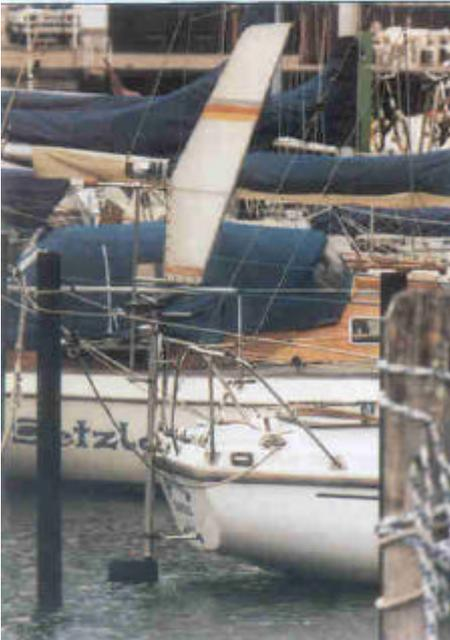
Ce système à safran auxiliaire Windpilot est idéal pour des bateaux jusqu'à 11 m/36 ft de longueur.
