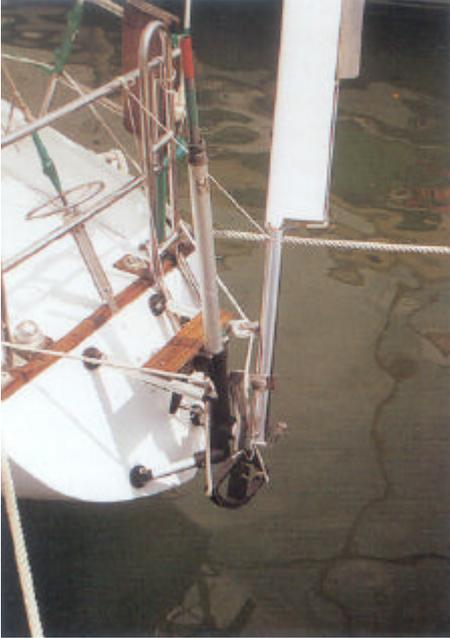
Le Bogasol – système à safran pendulaire assisté (type 11) de fabrication espagnole – a de nombreux points communs avec le système français Navik : la girouette agit sur un flettner monté sur le safran pendulaire, sans engrenage conique. Le pendulum peut être redressé latéralement.
