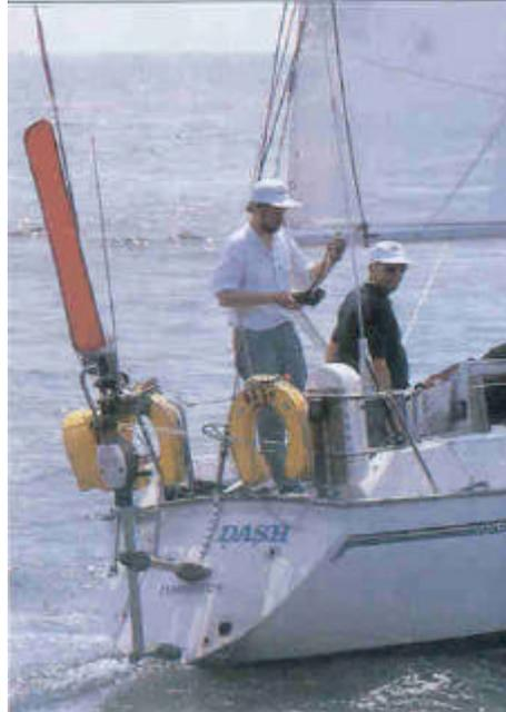
Le système à safran auxiliaire Hydrovane : la girouette horizontale génère plus de force qu'une girouette verticale Atlantik.
