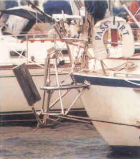
Les systèmes à safran pendulaire assisté traditionnels demandent souvent un bâti support réalisé sur mesure.
