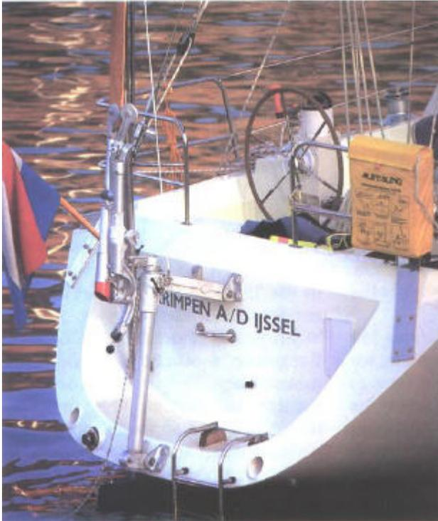
Tableau de type *Sugar Scoop* sur un Taswell 48 équipé d'un Windpilot Pacific Plus. Le bras de transmission du pendulum est relevé.
