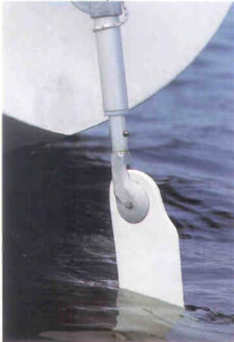
Le Windpilot Pacific fend les eaux en provoquant un minimum de remous.
