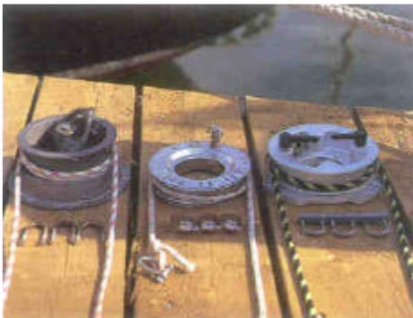
Trois adaptateurs de barre à roue (de gauche à droite) : Aries, Monitor et Windpilot.
