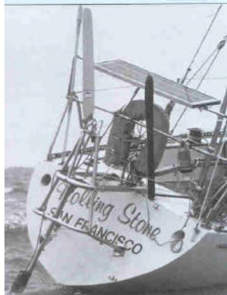
Ce régulateur d'allure Windpilot Pacific à girouette verticale et safran pendulaire assisté MKI (1969) est en acier inoxydable.
