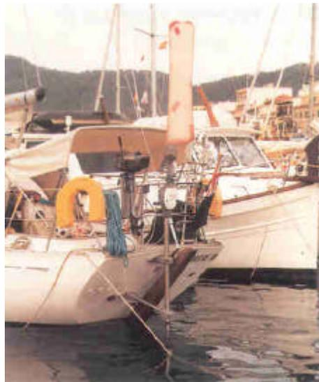
Montage excentré à côté d'un gouvernail hors bord. L'écart latéral doit être de 30 cm/12 in.
