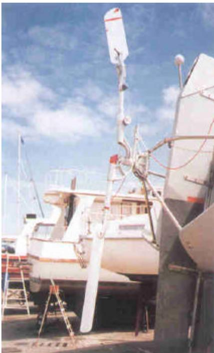
En se déplaçant latéralement, le safran pendulaire génère des forces qui sont transmises au safran principal. Ces forces dépendent de la distance entre le pivot du bras et l'extrémité inférieure du safran pendulaire. Cette distance qualifiée de PL (longueur du levier de puissance) est généralement de 150 à 200 cm. Les pales des safrans pendulaires ont une taille d'environ  $0,1 \text{ m}^2$ .
