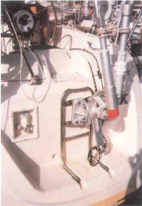
Il suffit de desserrer un boulon, d'enlever le système et l'échelle de bain est prête à l'emploi.
