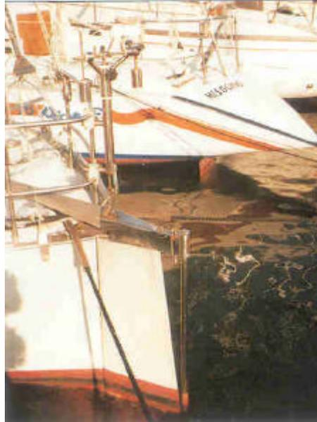
Régulateur d'allure à girouette verticale et safran principal doublé d'un flettner, spécialement conçu pour un bateau de 10m/32 ft dessiné par Olle Enderlein.
