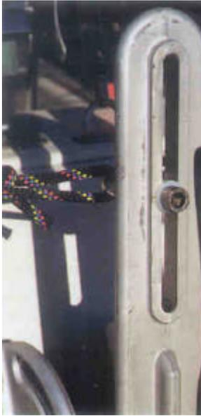
Le régulateur d'allure Windpilot Pacific (version 1998) est doté d'un adaptateur pour barre à roue réglable en continu.
