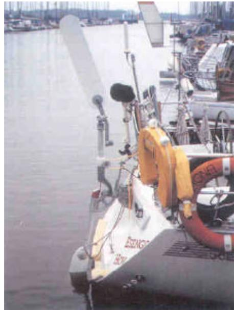
Grâce à son bras incliné, le safran pendulaire du Windpilot ne dépasse pas lorsqu'il est relevé.
