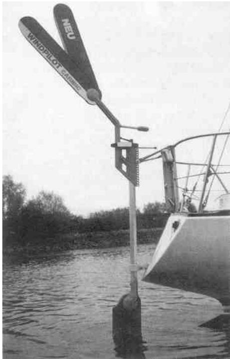
Système à safran auxiliaire Windpilot Caribik 1988
