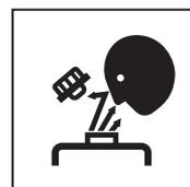
Ne jamais enlever le bouchon du réservoir de liquide de refroidissement alors que le moteur est encore chaud. De la vapeur et de l'eau bouillante peuvent en jaillir et causer de graves brûlures. Attendre que la température du réservoir de liquide de refroidissement ait baissé, entourer le bouchon de remplissage d'un chiffon et desserrer lentement le bouchon. Après vérification, resserrer fermement le bouchon.
