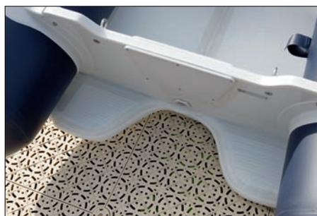
▲ Le plancher gonflable se prolonge en arrière pour former des stabilisateurs utiles au moteur.
