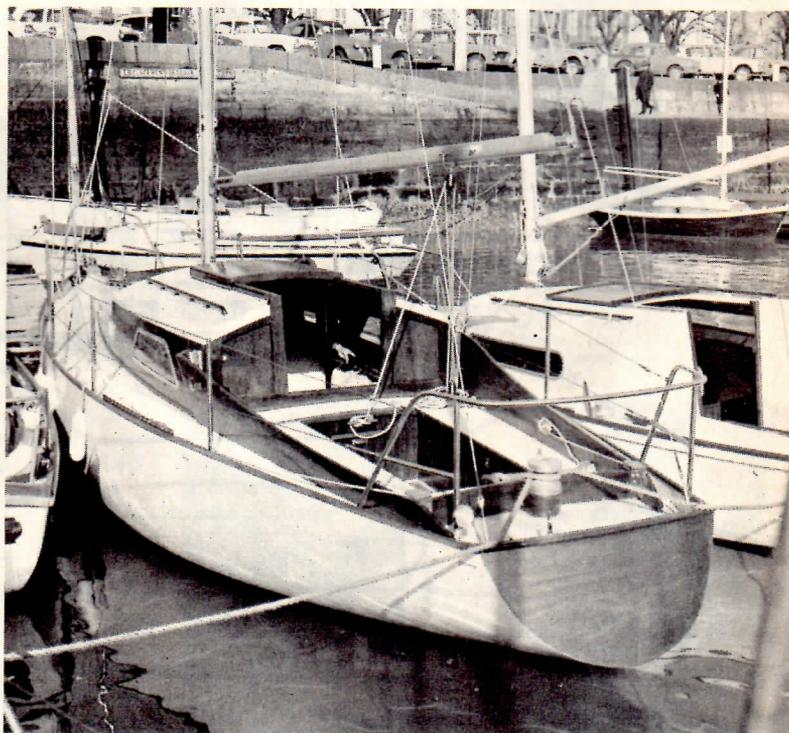
*En haut à droite, l'accastillage (ferrière d'étrave, chaumard, bittes) est bien disposé et solidement monté. Pour notre part, nous ajouterions un winch sur le mât pour étarquer la drisse du foc.*
