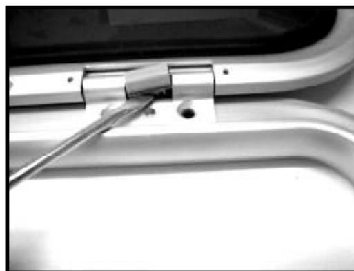
Réglage : faire pivoter l'axe boulon-écrou (voir photo) avec deux axes ou une petite clé six-pans. Pour augmenter le coefficient de friction, maintenir un élément en position fixe et faire pivoter l'autre dans le sens inverse des aiguilles d'une montre. Effectuer le réglage par pas de 1/4 de tour et vérifier le résultat.
