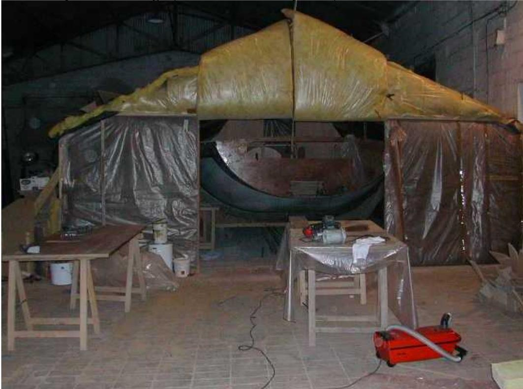
**équerrage de la quille et mise en place des serres**
