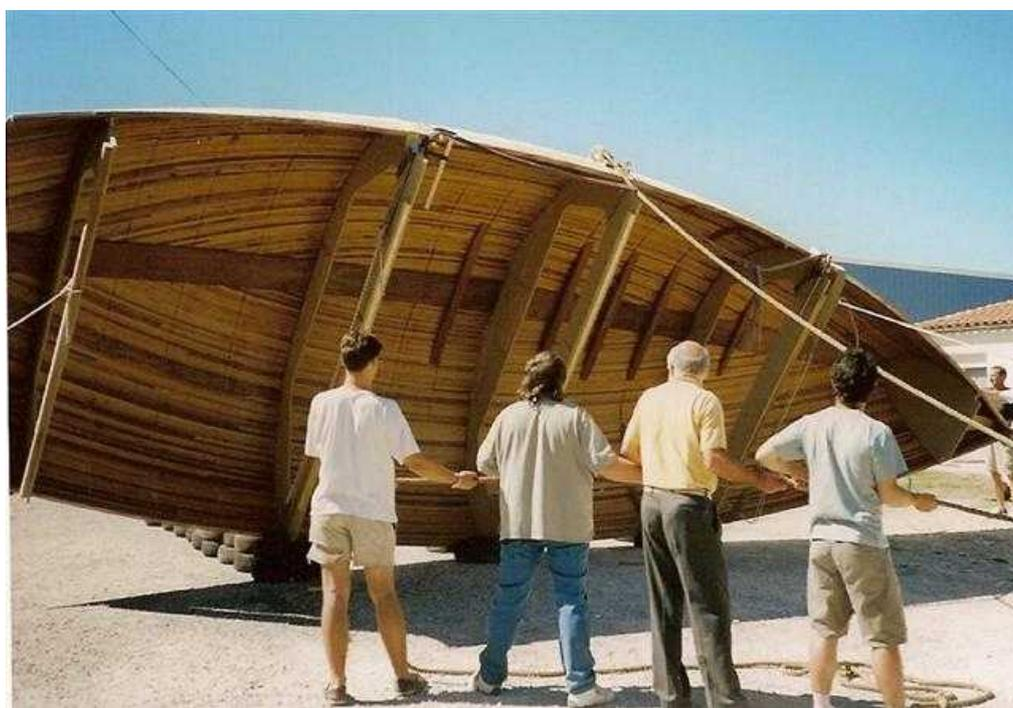
on tire d'un côté, on retient de l'autre
