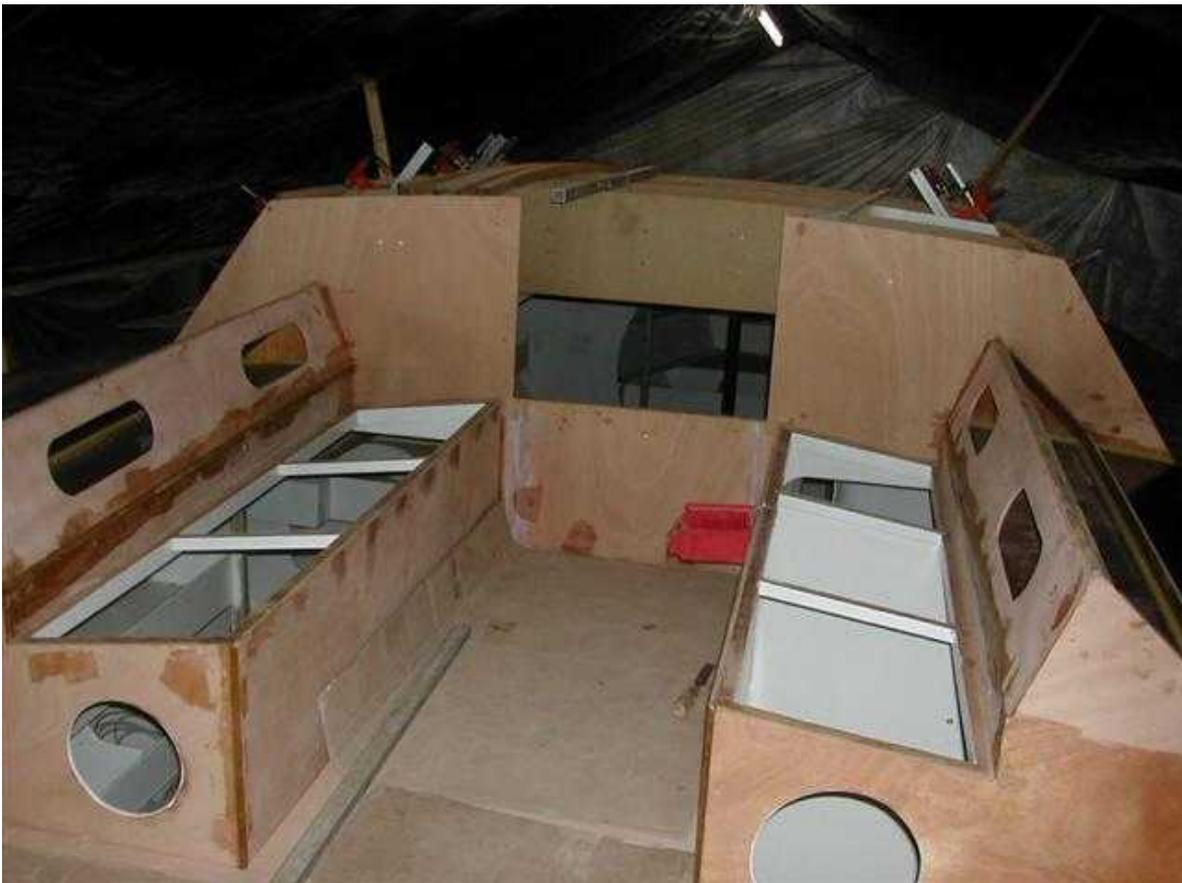
beaucoup de peintures ont été réalisées avant fermeture (facilité d'accès, évacuation des solvant , peinture à « l'endroit » des cp de pont,...)même si les collages suivants engendrent des retouches, idem pour les vernis des barrots
