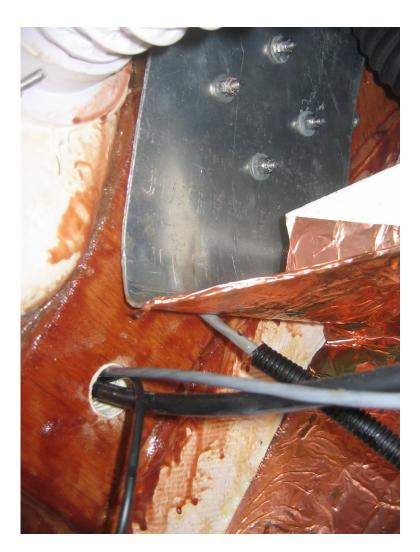
À l'intérieur du bateau, sur la plaque de montage du bossoir, j'ai collé du ruban de cuivre pour faire un contact capacitif avec le bossoir.
