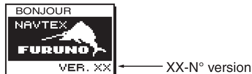
Figure 2-2 Fenêtre de mise sous tension
