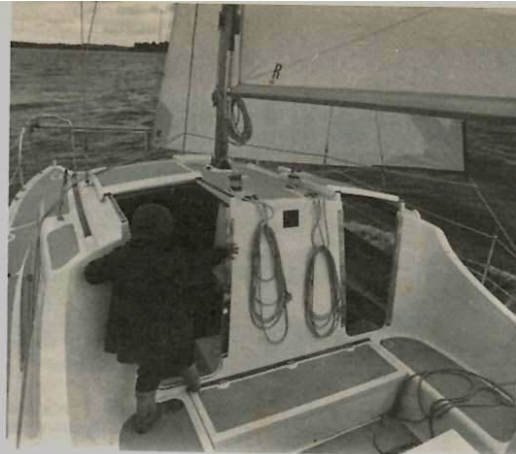
L'arrière du cockpit avec au centre le puits moteur dont le couvercle devrait pouvoir être saisi. Une barre relie les deux gouvernails.
