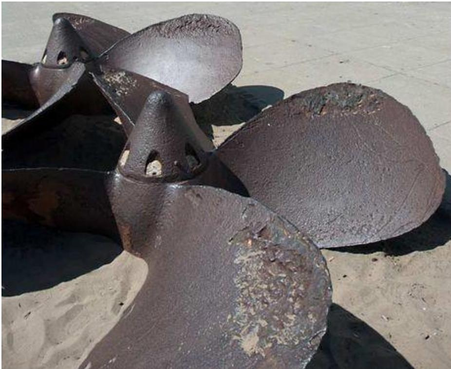
Lorsqu'une hélice ne fonctionne pas dans des conditions optimales, par erreur de calcul ou de dimensionnement par exemple, des vides se forment sur la face avant et/ou arrière de l'hélice. Ces vides sont engendrés par des successions rapides de variations de pressions au niveau local. Naturellement, le vide n'ayant pas sa place dans le milieu marin, il se comble
