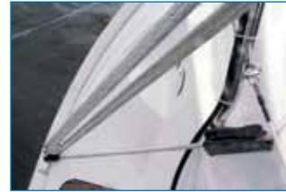
Le palan de patacas en cascade est efficace pour raidir l'étai avant. Il se manœuvre à la main et revient sur un simple bloqueur à came.
