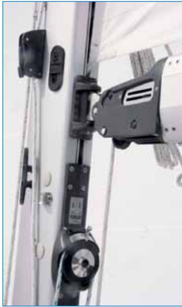
Le mât enrouleur Selden est d'excellente qualité. Au bas de l'image, la route crantée dans laquelle on peut insérer une manivelle pour débloquer la manœuvre d'enroulement.
