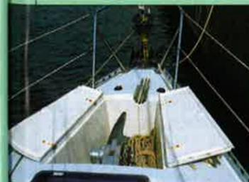
L'ancre se range sous le pont, dans un coffre aux côtés du guindeau.
