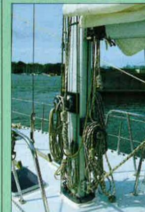
Le gréement dormant paraît d'origine : bonne tenue dans les parties basses. L'étai avant est équipé d'un enrouleur Profurl. Un étai largable est à poste avec ridoir à volant. Le gréement courant est à contrôler. La voilure en état comprend :
