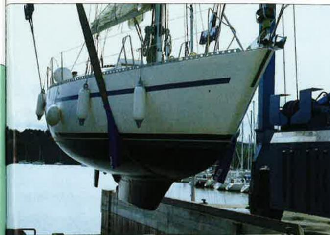
La longueur de la semelle et l'épaisseur du lest permettent au Sancerre d'échouer avec ou sans béquilles.
