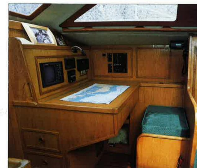
Assis à la table à cartes, on profite de la vue sur l'extérieur. Sur sa face avant : le radar Furuno et la centrale NKE.
