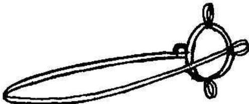
Mettre la cadène de tangon à cheval sur la cloison. La monter avec des contres plaques en monolithique de part et d'autre de la cloison, au plus près des congés
