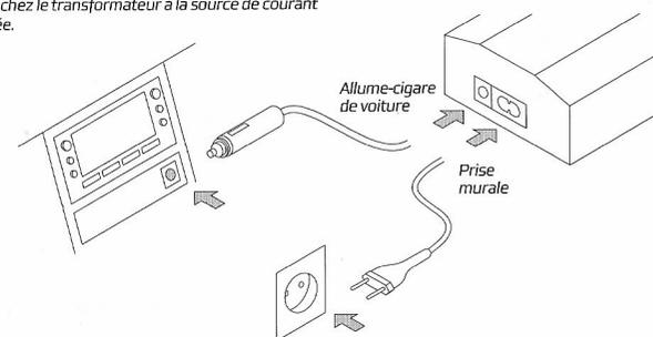
Utilisez un câble USB pour relier la prise USB de ce transformateur pour alimenter les équipements compatibles depuis cette connexion ou une prise de 5VCC, avec une intensité maximale d'1A.
