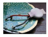
Souder les 2 fils de raccordement, sur chacune des faces, en prenant soin de **ne pas trop faire chauffer la batterie**.
