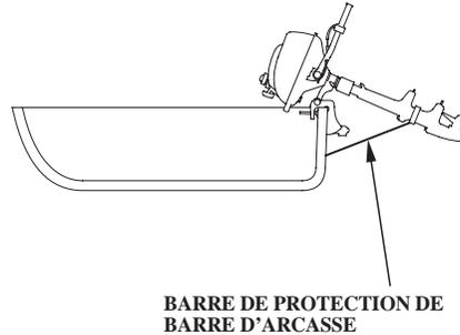
Le moteur doit être remorqué en position de marche normale. S'il y a dans cette position un espace de route insuffisant, remorquer alors le moteur en position inclinée en utilisant un dispositif de soutien de moteur telle qu'une barre de maintien de barre d'arcasse, ou déposer le moteur du bateau.
