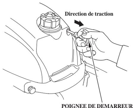
6. Tirer doucement la poignée de lancement jusqu'à ce que l'on ressente une résistance, puis la tirer d'un coup sec dans le sens de la flèche comme sur la figure ci-dessous.
