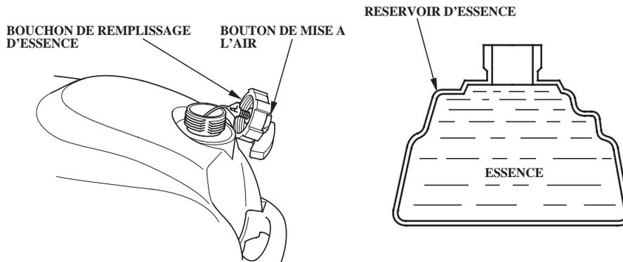
Déposer le bouchon de dispositif de remplissage de carburant, et vérifier le niveau de carburant. Remplir le réservoir si le niveau de carburant est bas.
