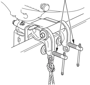
Utiliser les vis de fixation pour fixer les chaises d'arbre d'hélice à la barre d'arcaste.
