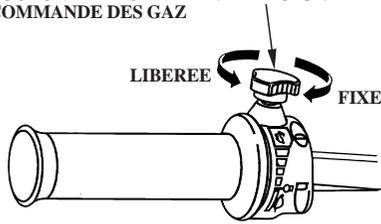
Utiliser le bouton de friction de poignée des gaz pour la croisière à une certaine vitesse constante. La rotation du bouton de friction de poignée des gaz dans le sens des aiguilles d'une montre bloque la poignée des gaz en place, et celle-ci peut être débloquée en tournant le bouton de friction de poignée des gaz dans le sens contraire des aiguilles d'une montre.
