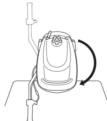
2. Pour inverser la direction, tourner le moteur hors-bord de 180°, puis pivoter la barre de gouvernail de la manière indiquée. Pour le type avec manette de commande des gaz, faire attention à ne pas tenir et déplacer la manette de commande des gaz lors du pivotement de la barre de gouvernail.
