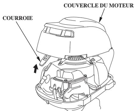
Utiliser la courroie de retenue pour maintenir le couvercle de moteur fermé ou déposer le couvercle de moteur.
