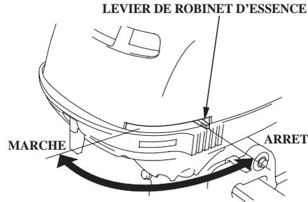
Tourner le levier de robinet de carburant vers la position ON pour ouvrir le robinet de carburant pour que le moteur tourne.
