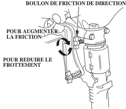
En cas de remorquage ou de transport du bateau avec le moteur monté, il est conseillé de laisser le moteur dans sa position normale de marche, en prenant soin de serrer à fond le boulon de serrage.
