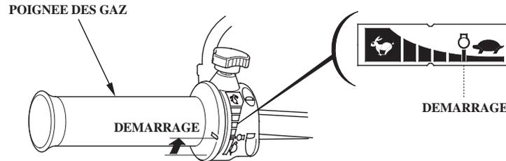
4. Déplacer le levier ou la manette de commande des gaz vers la position START (démarrage).
