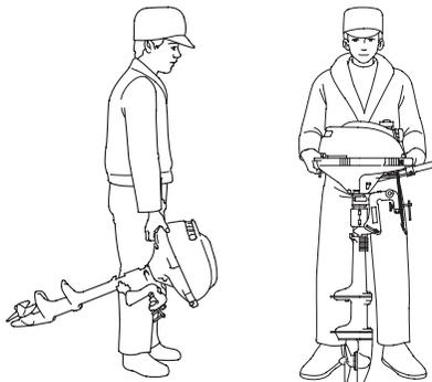
Pour transporter, tenir le moteur avec la poignée de transport, ou tenir avec la poignée de transport et la patte située en dessous de la courroie de retenue de couvercle de moteur, de la manière indiquée ici. Ne pas transporter avec le couvercle de moteur.
