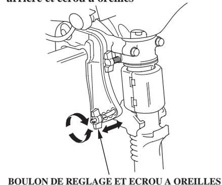
Utiliser le boulon de réglage pour ajuster l'angle de moteur à la position d'opération normale.
