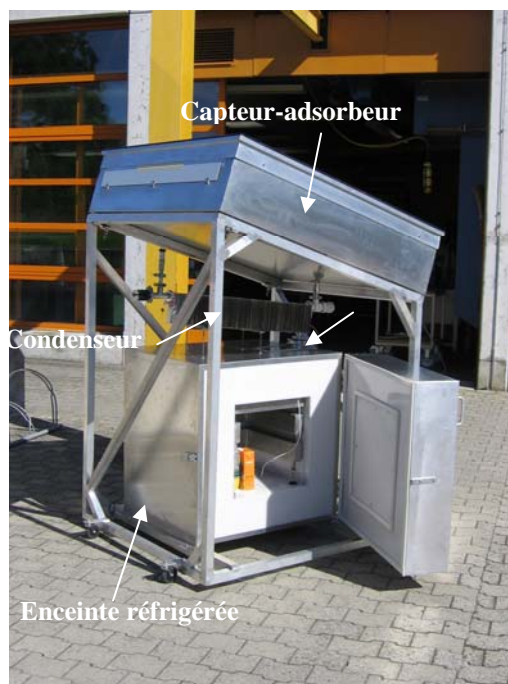
Figure 1 : Vue d'ensemble du réfrigérateur solaire à adsorption développé par le LESBAT (réfrigérateur testé dans un centre de santé en Erythrée dès l'automne 2005)
