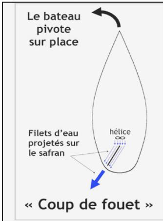
Il faut que des filets d'eau s'écoulent le long du safran pour qu'il ait un effet sur le déplacement du bateau. L'action du gouvernail est nulle à l'arrêt (comme en vélo) et augmente avec la vitesse.
