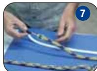
7 Entrez l'extrémité de l'âme dans l'aiguille et introduisez l'aiguille dans la gaine extérieure.
