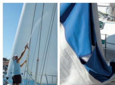
Un génois qui n'est pas bien enroulé, en cas de coup de vent, peut rapidement se déchirer. Un conseil, si vous avez un problème pour l'enrouler ou l'aifaler, il faut le ferler solidement avec une drisse pour éviter le minimum de prise au vent.
