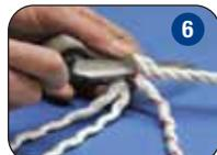
6 Passage des torons pour la 1<sup>re</sup> passe : 2<sup>e</sup> toron.
