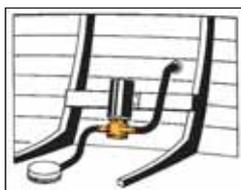
Pompe à turbine avec point d'aspiration et point de refoulement.
