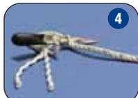
4 Passage des torons pour la 1<sup>re</sup> passe : 1<sup>er</sup> toron.
