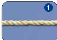
1 Placez la corde face à vous, puis faites une surliure en respectant le procédé suivant :  $10 \times le \varnothing + 50 \text{ mm}$  (exemple :  $12 \text{ mm} \times 10 + 50 = 170 \text{ mm}$ ).
