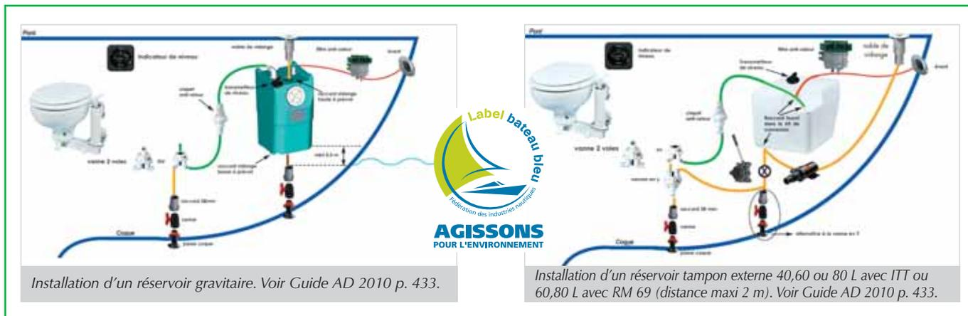
Installation d'un réservoir gravitaire. Voir Guide AD 2010 p. 433.
