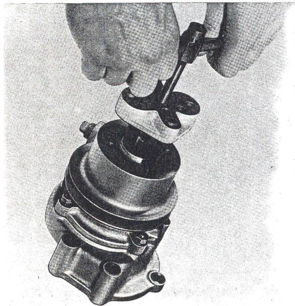
Fig. R8 — Dépose de la poulie de pompe à eau.
