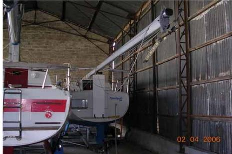
1) débrider le mat du balcon, de la jumelle, du support arrière, vérifier que rien ne gênera le roulage du mat vers l'arrière
