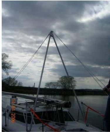
14) une fois le mat en place, reprendre la drisse de spi, la fixer sur le balcon et placer la plaque de bridage sur la jumelle
