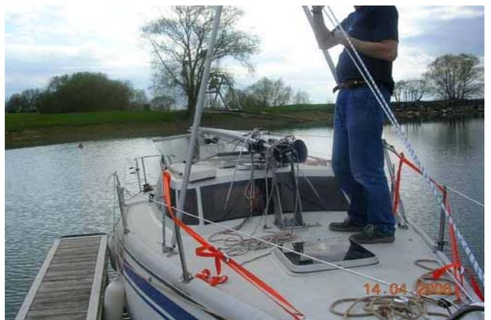
9) Passer un bout spectra (rouge) autour de l'axe de rotation de la jumelle et le reprendre à l'aide du palan de GV. L'objectif est de reprendre en partie les efforts de compression sur la jumelle par le palan
