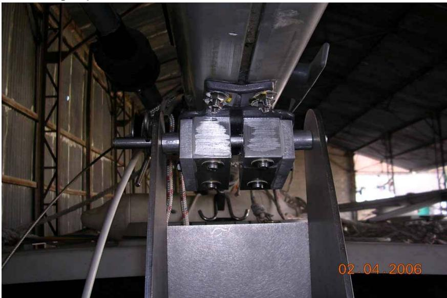
5) Mettre en place la chèvre (un des tubes et une des charnières est repéré "T" pour tribord) voir le croquis, la poulie en haut est sur l'avant. Placer la chèvre délicatement en appui sur le roof vers l'arrière.
