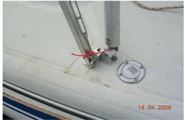
6) Mettre en place le circuit de drisse de levage: mettre une manille sur la latte tribord qui supporte normalement le tambour d'enrouleur. Nœud de chaise sur la manille, passer le bout dans la poulie de la chèvre. Mettre une poulie sur la latte babord, passer le bout dedans. Mettre une poulie (fixée avec un bout) sur le chandelier au niveau du roof à babord. passer le bout. Passer le bout dans la poulie coinçeuse de l'enrouleur et sur le winch babord.
