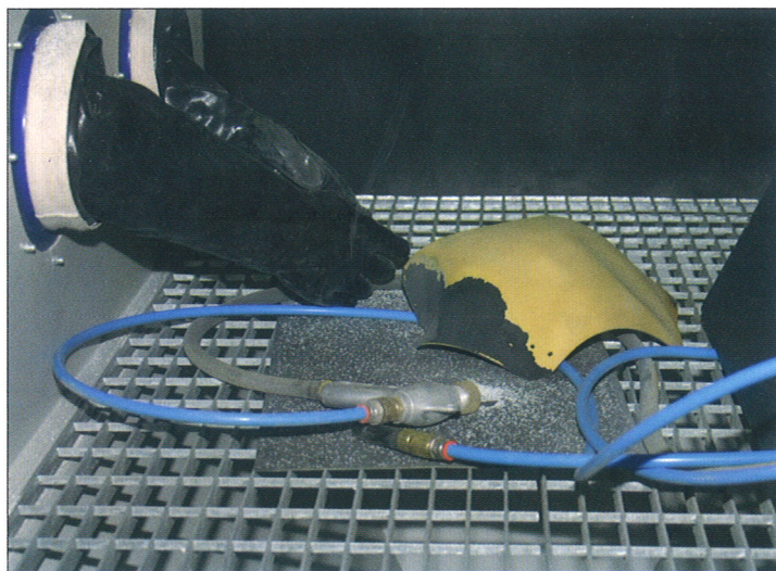
L'utilisateur doit toujours s'assurer que l'équipement de sablage est compatible avec le choix de l'abrasif
