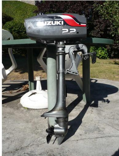
Le constat est simple : mon hors bord ne refroidit plus, je peux peine poser la main sur l'embase tellement c'est chaud. C'est parti pour un démontage afin de nettoyer le circuit de refroidissement
