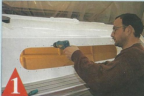
**1** Après une nouvelle peinture... mieux vaut repercer les trous de vis au bon diamètre.
