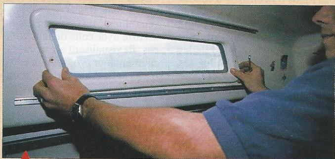
**2** Pour démonter le hublot, il faut commencer par déposer le cache installé à l'intérieur du rouf. Ici, les vis sont venues sans difficulté.
