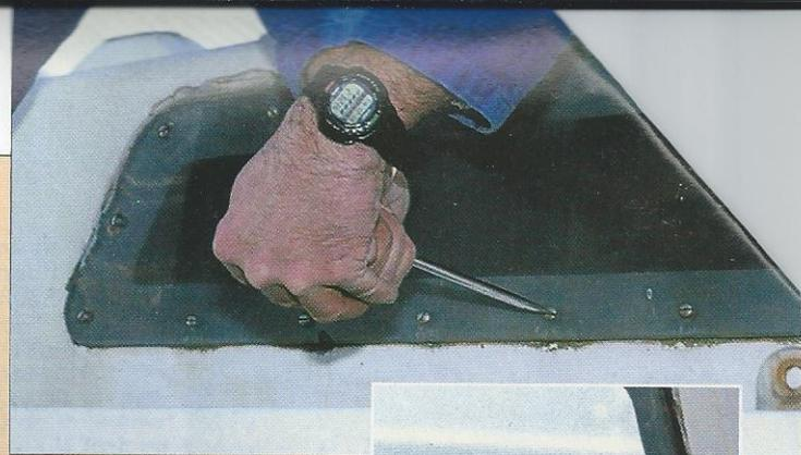
**3** Le dévissage des boulons commence. Il faut être deux : une personne à l'extérieur, armée d'un tournevis et une autre à l'intérieur qui bloque l'écrou à l'aide d'une clé plate. Ce n'est pas trop difficile mais pensez à utiliser une boîte pour ranger la boulonnerie au fur et à mesure que vous l'ôtez.
