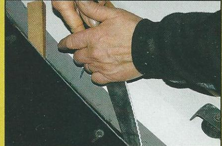
On le trouve plus souvent en cuisine qu'en atelier, mais il s'agit bien d'un couteau à pain. C'est l'outil idéal pour couper le joint sous le hublot si celui-ci est trop attaché à son support. La lame relativement souple se glisse facilement sous le plexiglas, les dents entaillent le joint et le manche assure une bonne prise en main.
