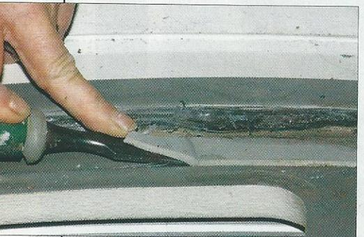
Après avoir enlevé le hublot, le joint mousse est décollé au ciseau à bois. Frédérique retire ensuite tous les résidus du joint congé au cutter puis dégraisse la surface d'application du futur joint au trichloréthylène.
