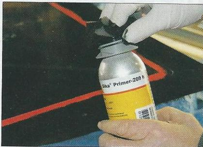
Frédérique prépare la surface d'accroche sous le hublot. Le plexiglas est poncé au grain 240 et dégraissé au Cleaner-205. Une couche de primaire (Sika-209 N) est appliquée à l'aide d'un tampon-feutre pour améliorer l'adhérence du futur joint.
