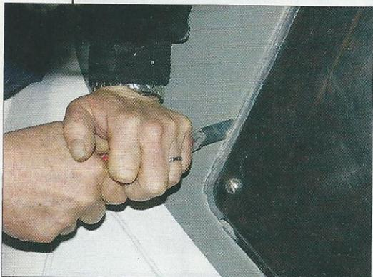
Le joint congé qui entoure le hublot est coupé au cutter. Puis c'est au tour des vis d'être retirées.
