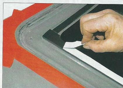
Le joint mousse, qui se présente sous forme de bande autocollante double face, est posé au bord de la gorge et non pas au milieu comme l'ancien. C'est sur lui que le plexiglas va venir s'appuyer.
