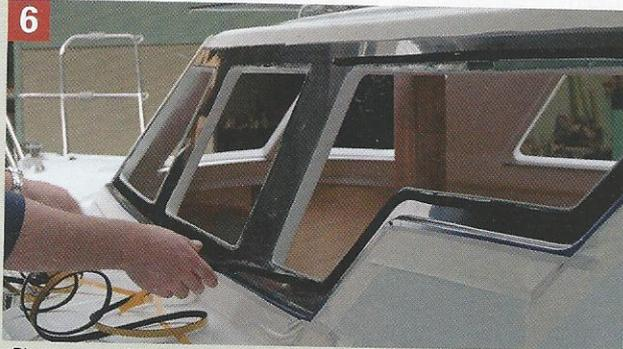
Placer un petit joint d'étanchéité sur la coque pour éviter les coulures.
