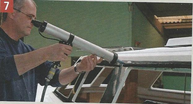
Appliquer la colle (Betamax) à l'aide d'un pistolet. Veiller à ce que l'épaisseur soit la plus uniforme possible (quelques millimètres).
