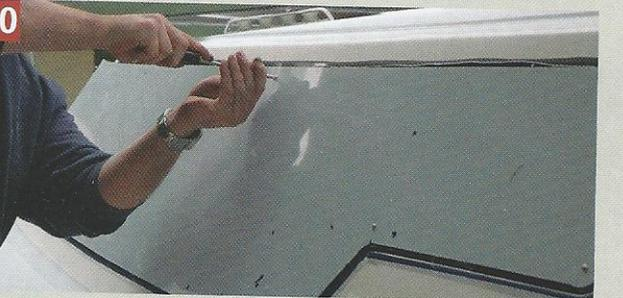
Une fois le hublot en place, poser les vis pour maintenir la pression et calibrer l'épaisseur. Au bout de 24 heures, poser un joint congé de finition.
