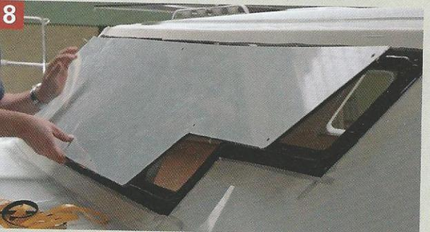
Positionner le hublot. Cette étape est particulièrement délicate: pour un bon centrage, placer des guides (pointes) dans les trous de fixation.
