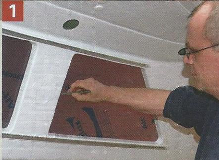
**1** Mettre provisoirement le hublot en place et tracer un trait sur son pourtour à l'intérieur du bateau pour délimiter la zone à coller.
