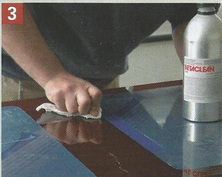
**3** Nettoyer et dégraisser (Betaclean) la partie à coller. La même opération de dégraissage est effectuée au niveau de la coque.
