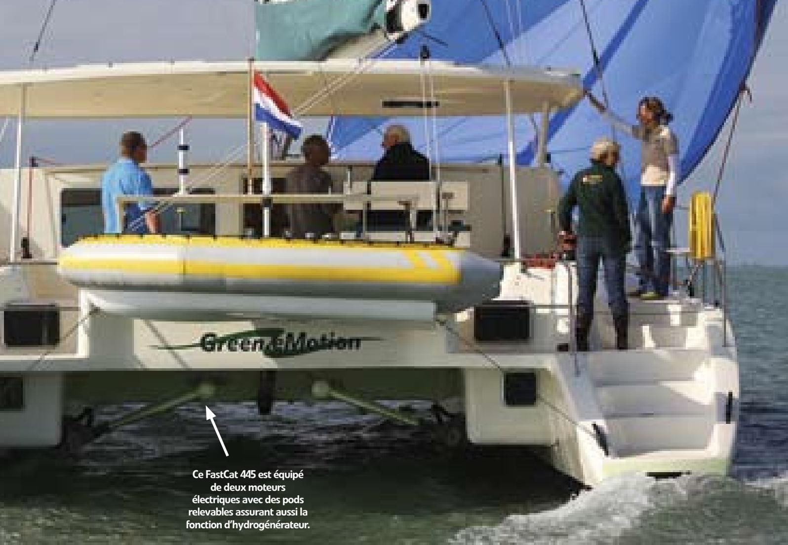
Ce FastCat 445 est équipé de deux moteurs électriques avec des pods relevables assurant aussi la fonction d'hydrogénérateur.
