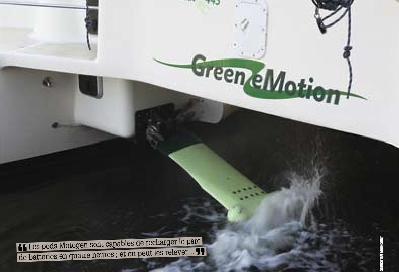
“ Les pods Motogen sont capables de recharger le parc de batteries en quatre heures ; et on peut les relever... ”
