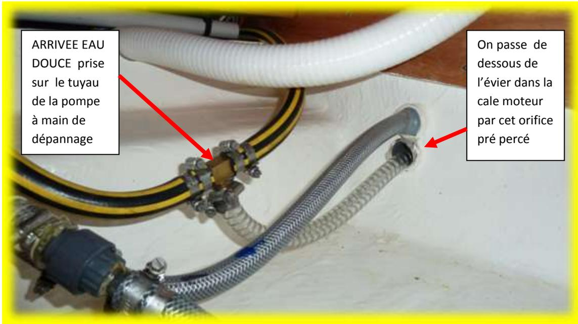
Alimentation en eau douce de la pompe de réfrigération, sur le réservoir principal du bateau
