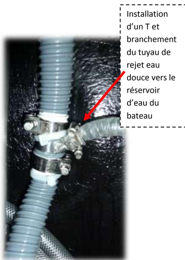
Rejet eau douce dans le réservoir du bateau par le tuyau de remplissage d'eau
