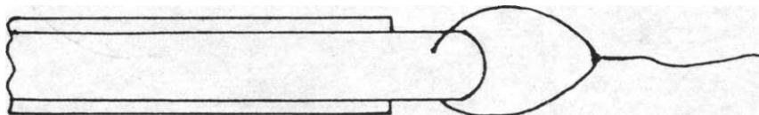
4- Prendre l'autre extrémité de l'âme, la sortir d'environ 30 cm et en couper une longueur = 1,5 cm par mètre de cordage + 4 cm. Puis épointer la coupe (Cf 2-). Sortir l'âme du côté libre et repousser la gaine du côté fil à voile jusqu'à arriver au repère.
