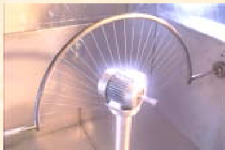
Essai IPX4 sur un moteur
